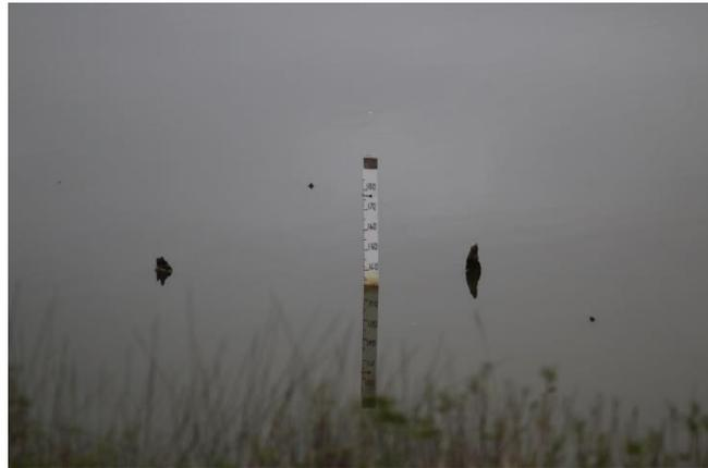
Figure 3: Echelle de mesure du niveau du bassin de rétention
